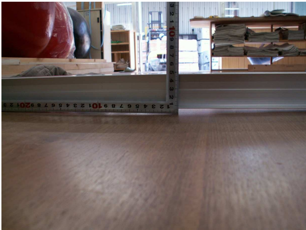
天板の短辺方向の反り状況です。中央で7 mm。
