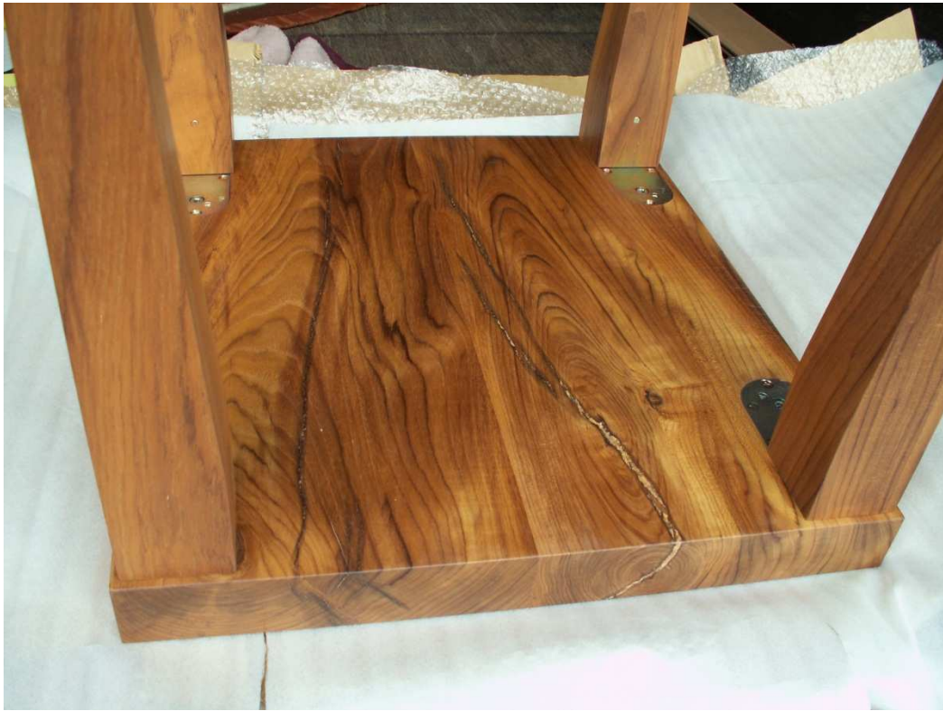
天板裏面のひび割れ状況です。
