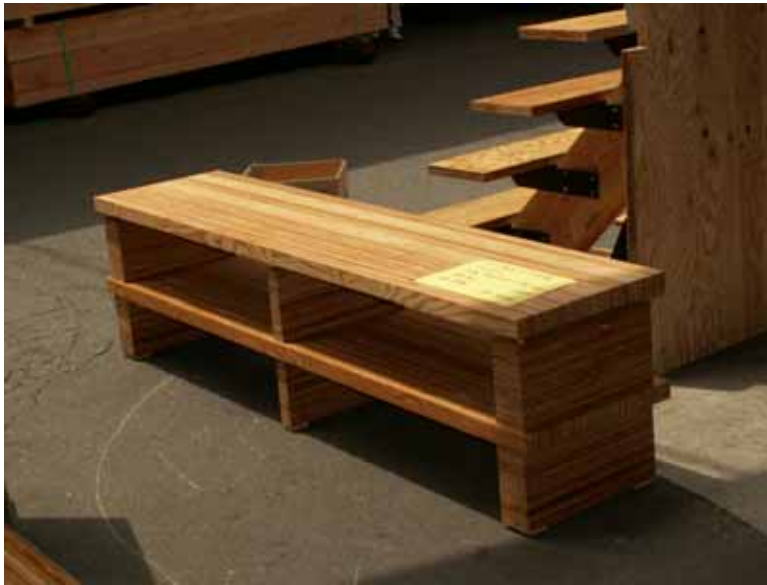
TV ポート` 試作例 平行柄がくどかった。 パーツで運んで現場組み。 大変重たい家具でした。
