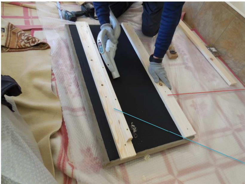
座面に補助板 t20 を取り付けて、箱と座面が直接擦れ無いうにしています。
