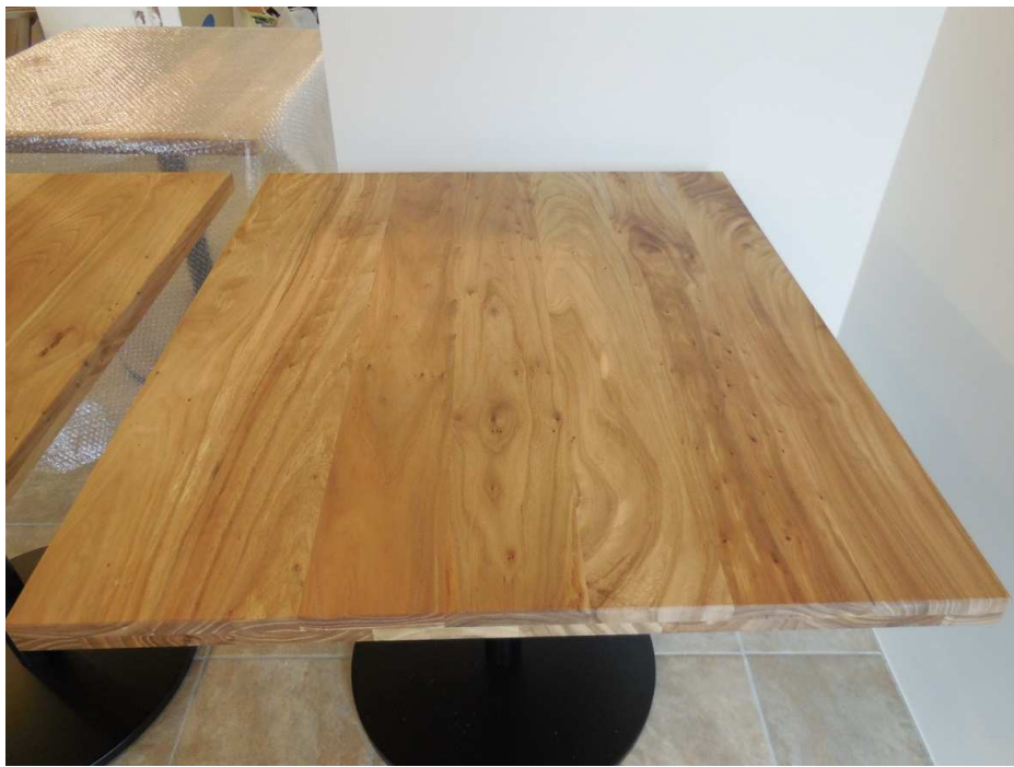
天板剥ぎ合わせ状況。
