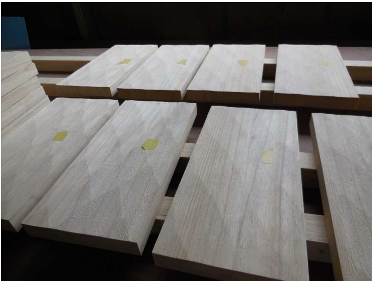
桐背板を亜鉛素酸ナトリウム 25%水溶液にて漂白し、乾燥状況。
