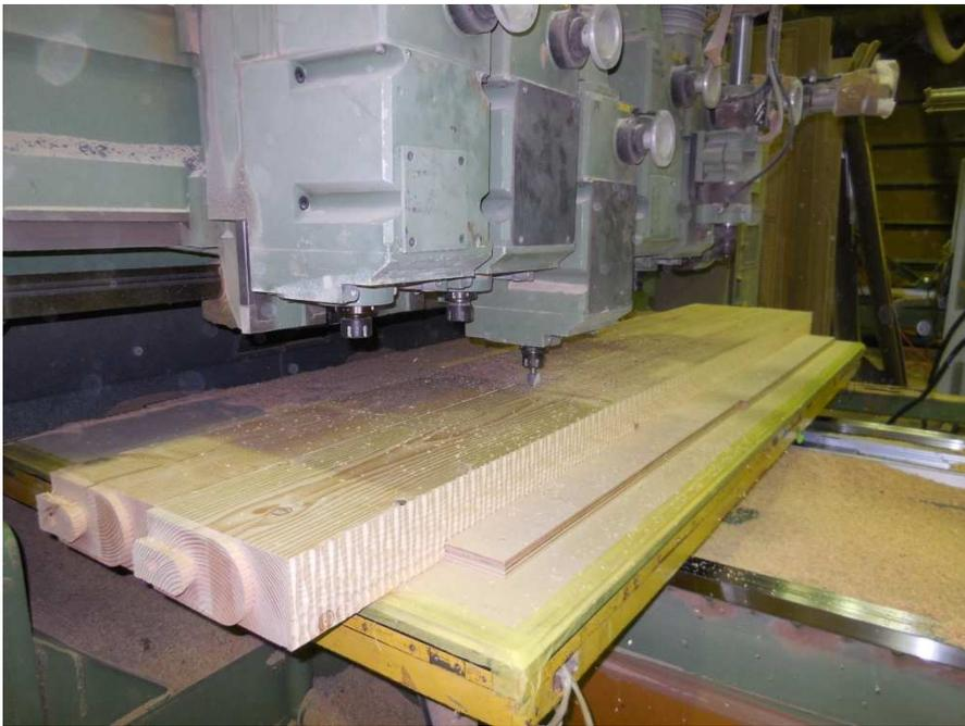
加工効率を上げるため、梁の左右の側面の加工は 2 本並べて加工致します。
