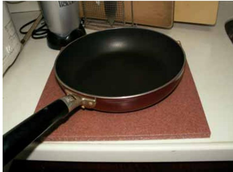
参考資料 試験温度 100 試験条件アルミニウム製平底ヤカン( 140)に水 500CC を入れて沸騰させて 100 にした時、そのヤカンを人大(デュポンコーリヤン)の試験体に 20 分静置し、異常なし。あくまでも目安です。人大メーカーによっても差があります。
