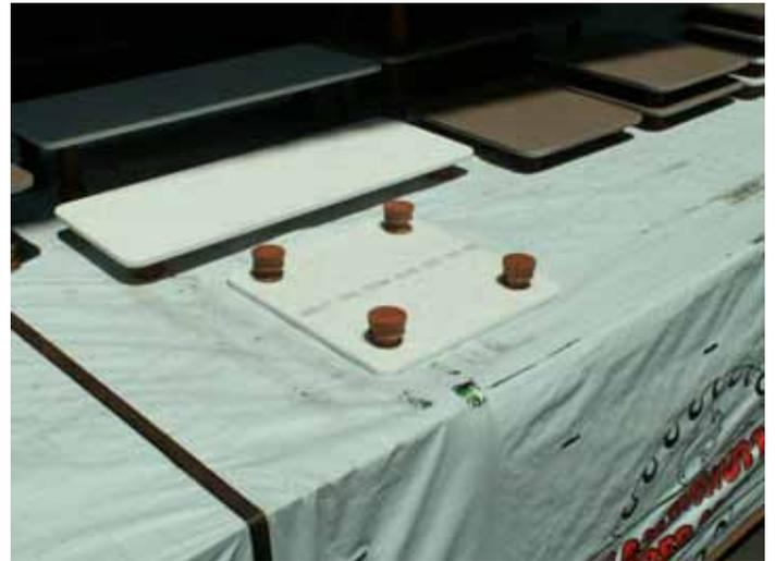
短尺脚のみの接合です。(H150mm ぐらいまで。) それ以上の高さは木製幕板を回して幕板に脚固定する必要有り。
