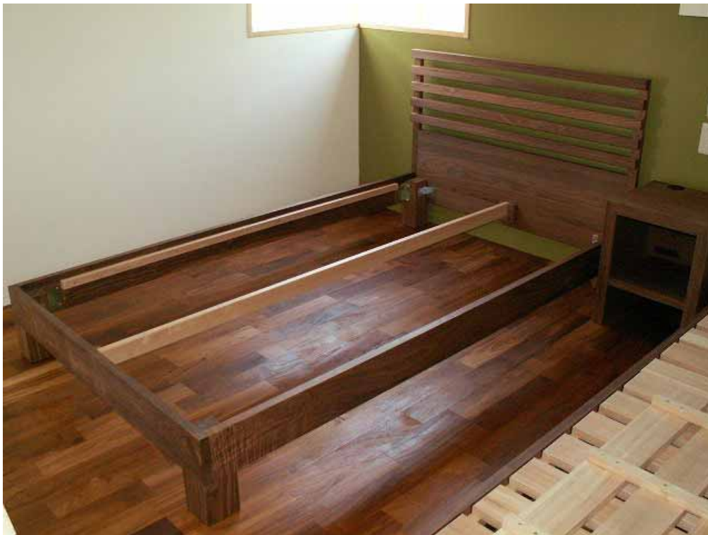
フレーム組み立て完了。中央たわみ防止材を取り付ける。
