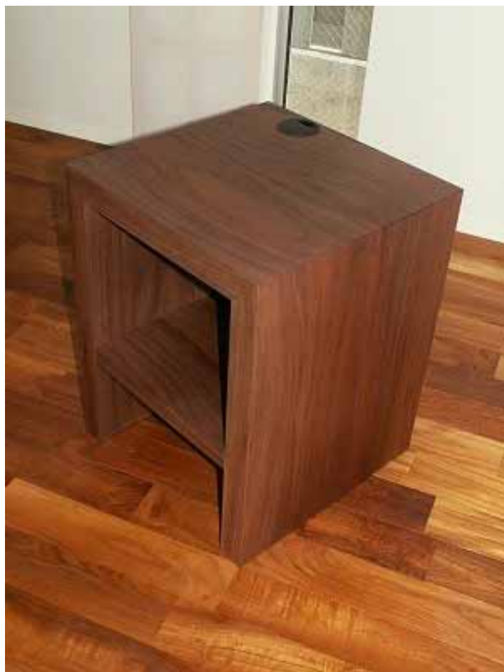
正面側より 杔目合わせの仕上がり状況。
