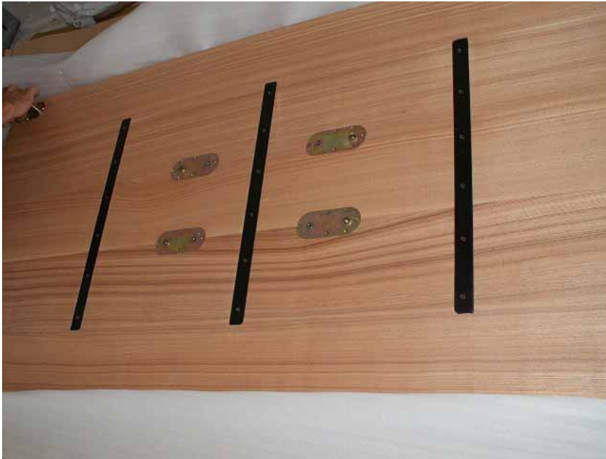
反り止め等辺アングル鋼の固定状況。 ムラコシ製脚固定金具レッグ FixB の 取り付け状況です。
