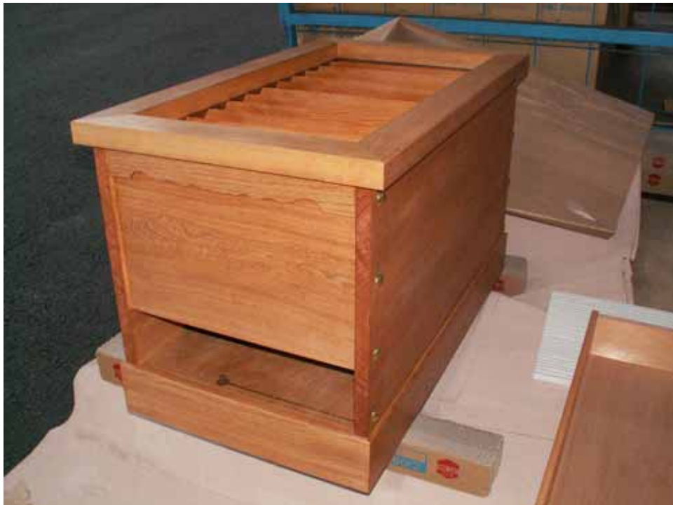
賽銭受け引きだし部の仕上がり確認です。 また、シリンダー錠の掛かり具合の確認も致します。
