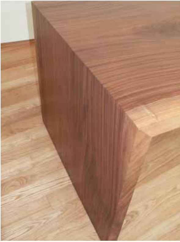
奥側の天板、板足の接合状況です。
