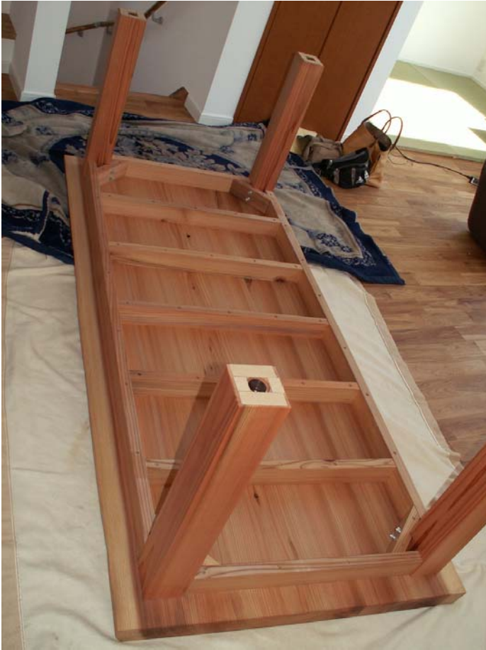
脚部、幕板、裏棧取り付け状況。
