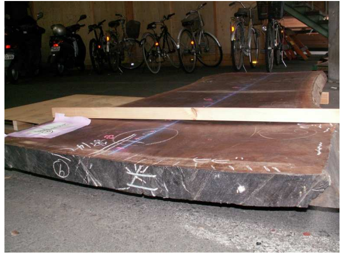
天板の反り状況。
