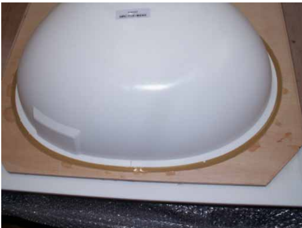
中央のボウルまわりにポリウレタン樹脂を流しこんで固定しています。
