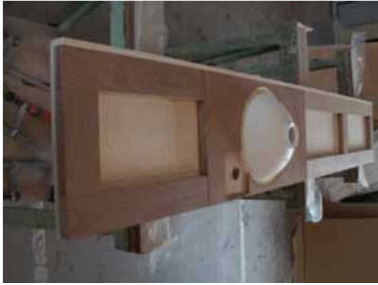
人工大理石ボウル取り付け状況。
