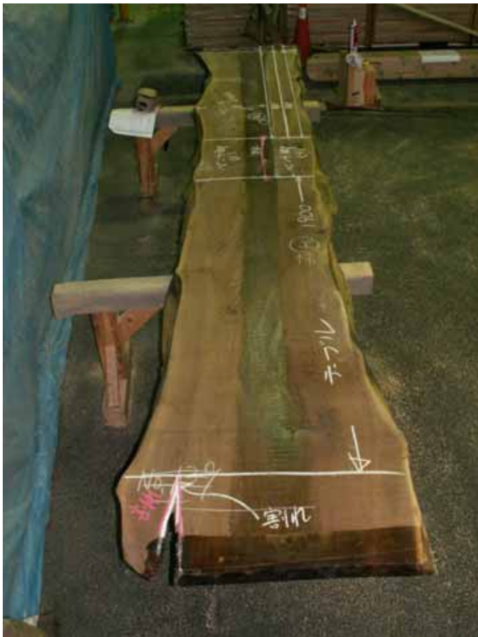
割れ、節等を確認しながら木取りの墨だしを行い、丸鋸でカット致します。 (株)マルダイ プレカット作業ヤードにて
